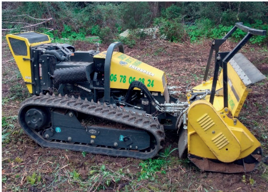
Un exemple d'engin léger : un chenillard télécommandé avec chenille en caoutchouc (CEN Corse)
